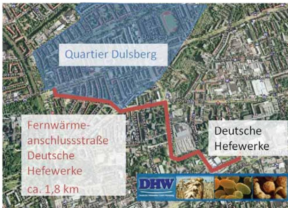
Abbildung 45: Mögliche Fernwärmetrasse bei Einbindung von industrieller Abwärme der deutschen Hefewerke
